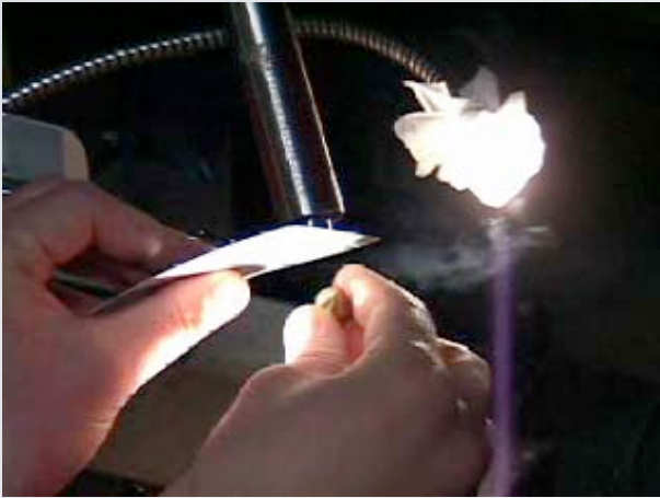
ループプレスマウント法でフラッシュ クーリングをしている様子
